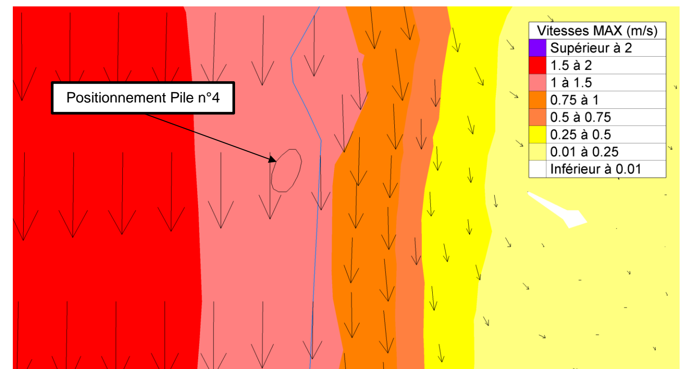
Figure 59 : Cartographie des vitesses maximales pour la crue de 1910 en situation initiale
