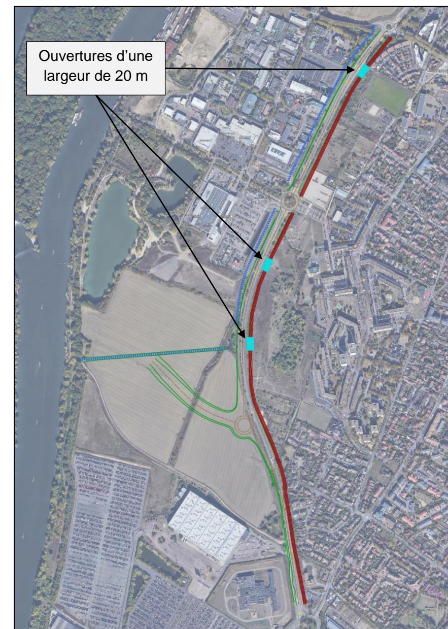
Figure 72 : Positionnement des 3 ouvertures de 20 m dans les murs anti-bruit
