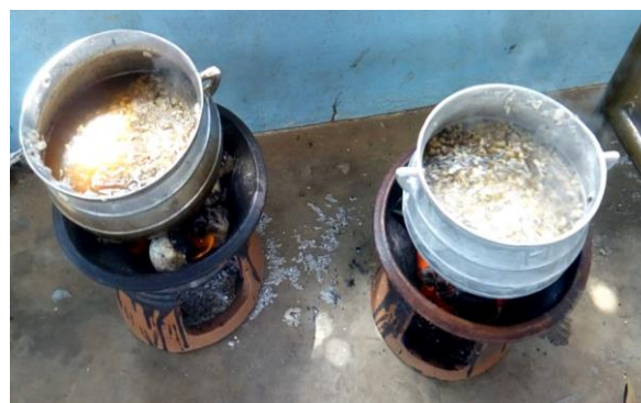
Expérience de cuisson du haricot sur deux foyers alimentés l'un en charbon et l'autre en buchettes combustibles
