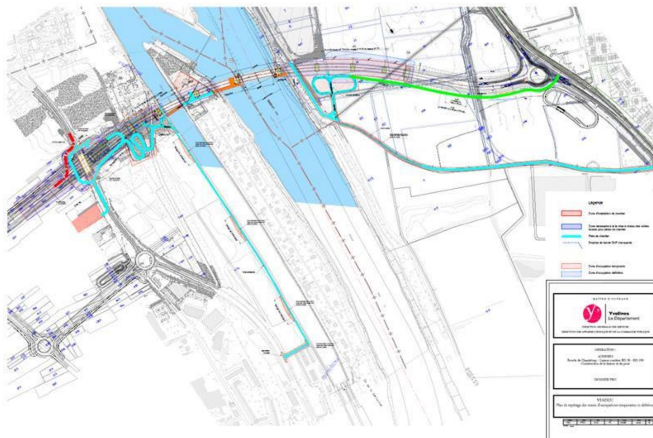
Localisation de l'estacade, des installations de chantier et des pistes pendant la phase travaux
