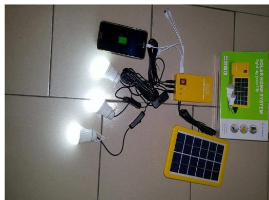
**Figure 20 : Kits solaire pour éclairage et recharge téléphone**
