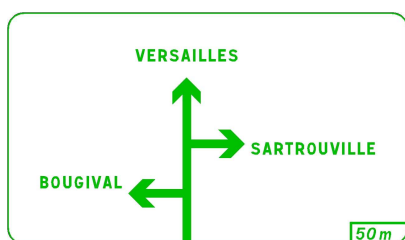
Dv42a - Panneau de présignalisation diagrammatique des carrefours complexes
