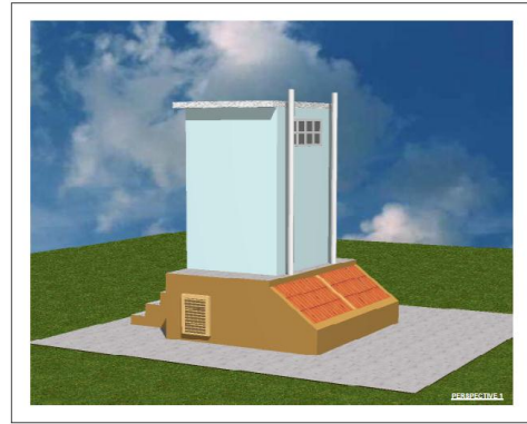
Latrine à fosse ECOSAN
