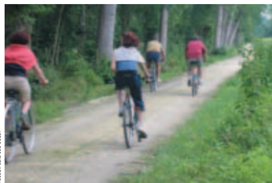
O. GOMET/CETE SUD-OUEST Voie verte en sablé stabilisé (mécaniquement) dans le marais poitevin utilisé par les cyclistes et d'autres catégories d'usagers
