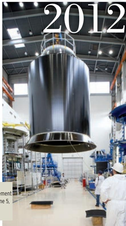
Fabrication du système de lancement double pour Ariane 5, avant le passage à Ariane 6.
